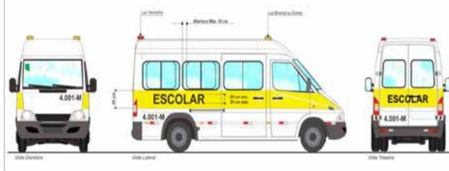
Padronização externa para ônibus e micro-ônibus
